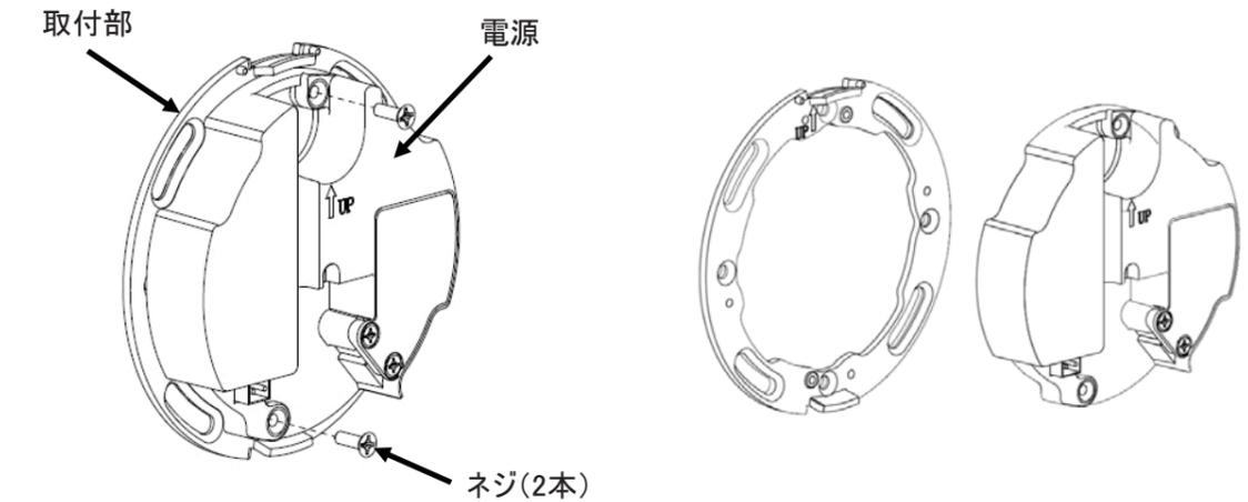
3. 付属のプレート用ネジ(4本)でボックス用プレートを取付部に固定してください。
