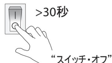
壁スイッチをオフにして、30秒以上待ちます。壁スイッチをオンにすると、常に設定した明るさでLEDが点灯します。
