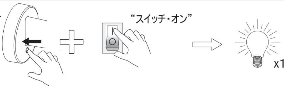
スイッチを押しながら、壁スイッチをオンにしてください。LEDが1回光ります。スイッチは押しただままにしてください。
