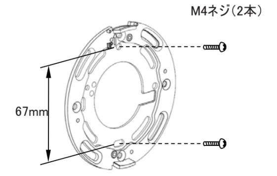
5. 電源の端子台カバーを取り外してから、電源をネジ(2本)で取付部に固定してください。
