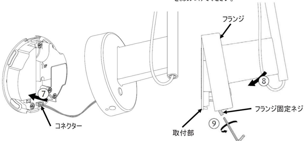
3. 端子カバーをはめ、取付ネジ4本で取付部を壁に取り付けてください。
