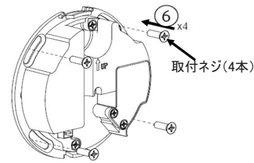
5. フランジを取付部にかぶせ、フランジ固定ネジを締めつけてください。
