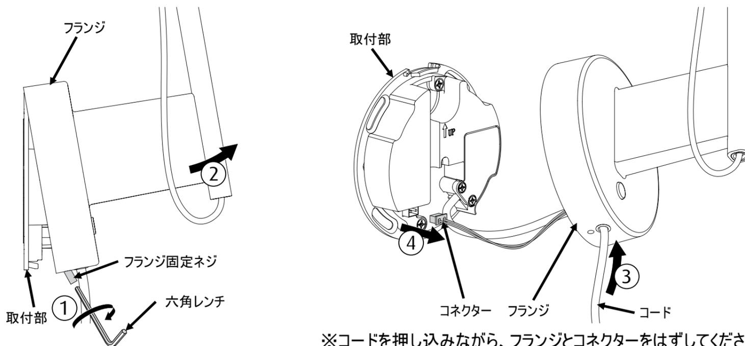
2. 取付部のネジ(2本)をゆるめ、電源を取り外してください。
