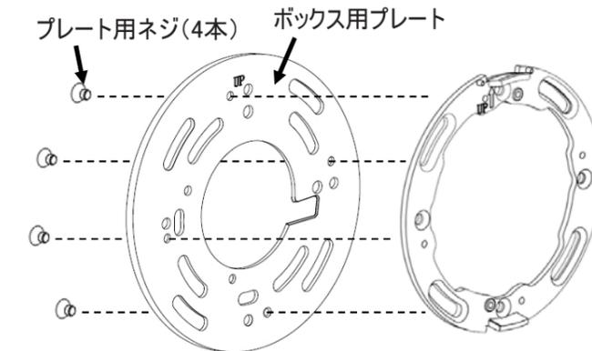
4. 取付部を固定したボックス用プレートを付属のM4ネジ(2本)で埋込ボックスに固定してください。
