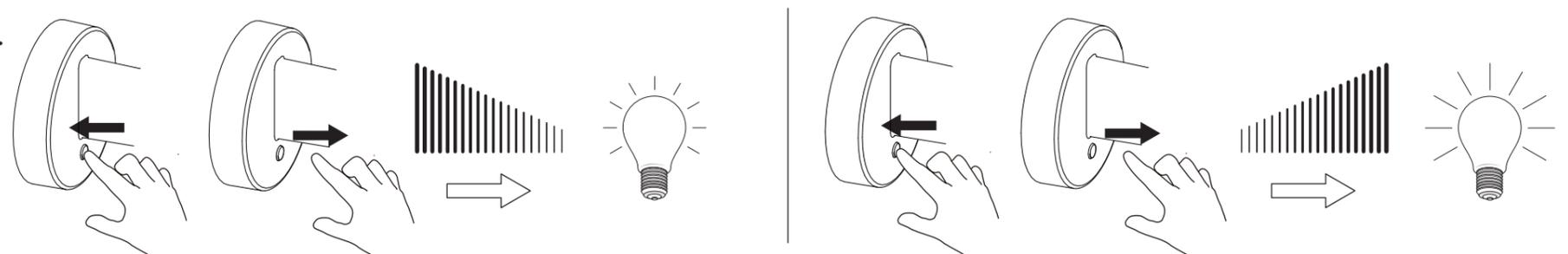
スイッチを押して点灯後、一度指をはなし、再度スイッチを押しつづけて明るさを調整してください。
